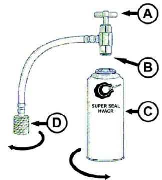
5. Entfernen Sie den Schlauch (D) von der Vakuumpumpe während sie läuft, um so das Vakuum im Schlauch zu behalten. Schalten Sie die Vakuumpumpe nach dem Abtrennen aus.
