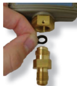
De filter beschermt de sensor
