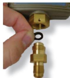
Capteur protégé par le filtre
